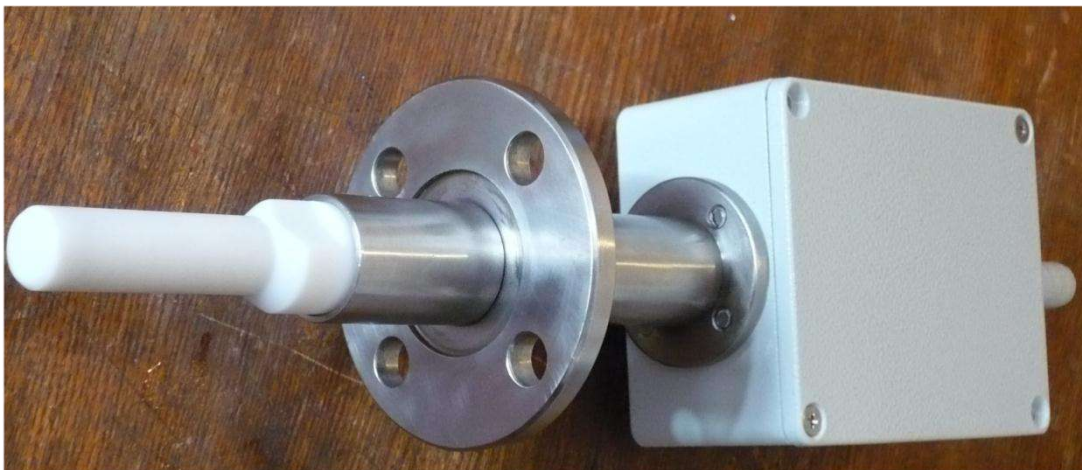
Рисунок Б.10 – Внешний вид первичного преобразователя КС-1М-4, предназначенного для установки в тройник и врезки в стенку бака.
