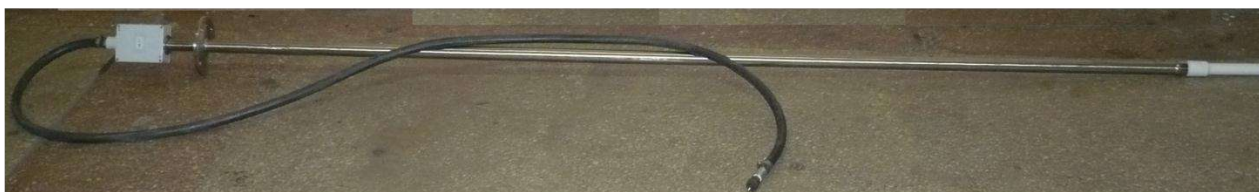
Рисунок Б.10 – Внешний вид первичного преобразователя КС-1М-4, предназначенного для установки в тройник и врезки в стенку бака.
